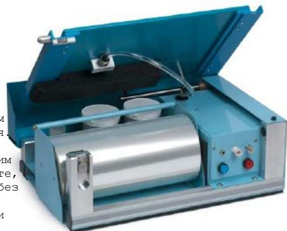
Отображающая пленка и каскадный проявитель хранятся внутри под вакуумной камерой, что удобно при перевозке. Для подготовки прибора к работе надо лишь надеть катушку с пленкой на специальные штифты.
